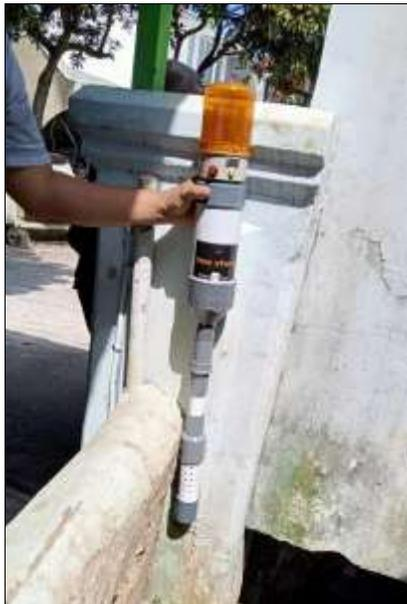
**Gambar 16. Penempatan Alat Sensor Banjir**
