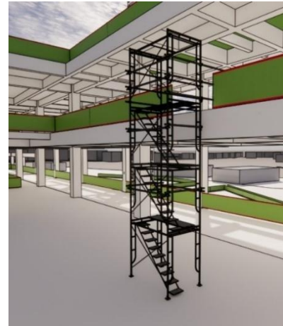
Gambar 13 Pemodelan Tangga Scaffolding Pada Lantai Utama-Lantai 3
