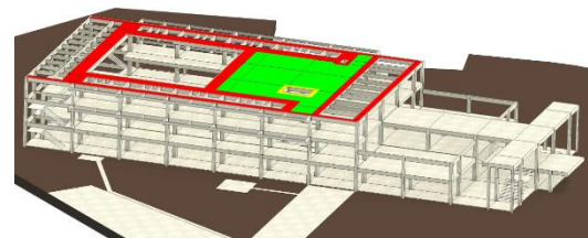
Gambar 9 Area Berbahaya Pada Lantai Atap
