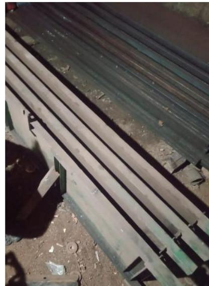
**Gambar 10. Pembuatan Alat Cetak Panel Pracetak**
