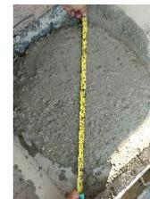
**Gambar 5. Pengujian Beton Segar**
