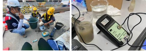
Gambar 2 Penguji Nilai PH dan TSS
