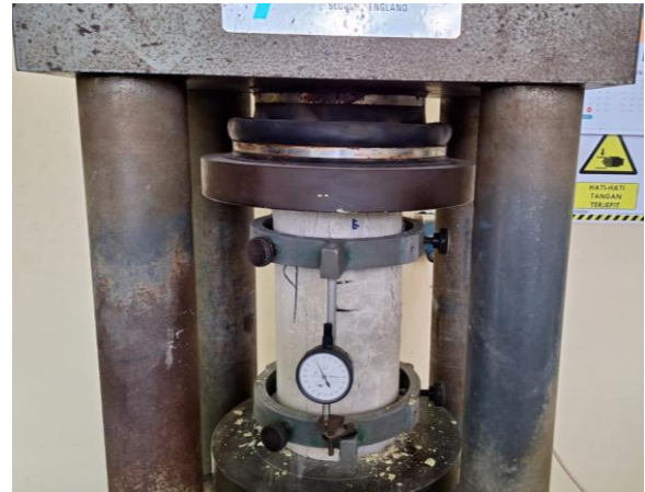
Gambar 1. Pengujian Kuat Tekan Beton
