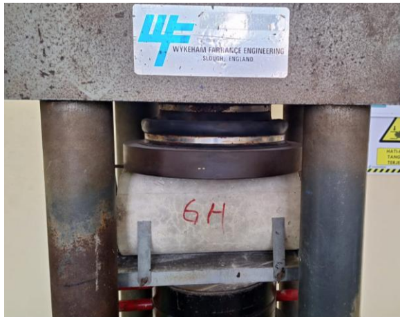
Gambar 3. Pengujian Kuat Tarik Belah Beton
