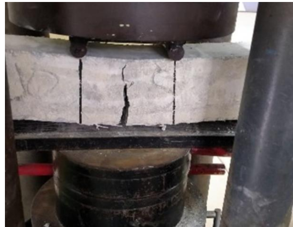
Gambar 5. Pengujian Kuat Lentur Beton
