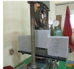
**Gambar 5. Foto Benda Uji di Alat Penguji**
