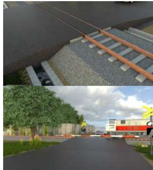
Gambar 6 Perspektif Perkuatan Perlintasan Menggunakan Plat Beton Bertulang
