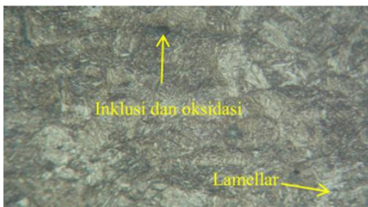
Gambar 3a. Struktur Mikro Pegas A Celup Getah Pohon Pisang
